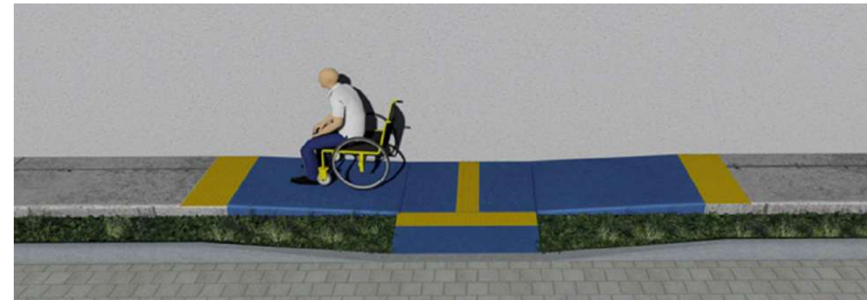
Persp. ilustrativa – Rampa estreita com canteiros
