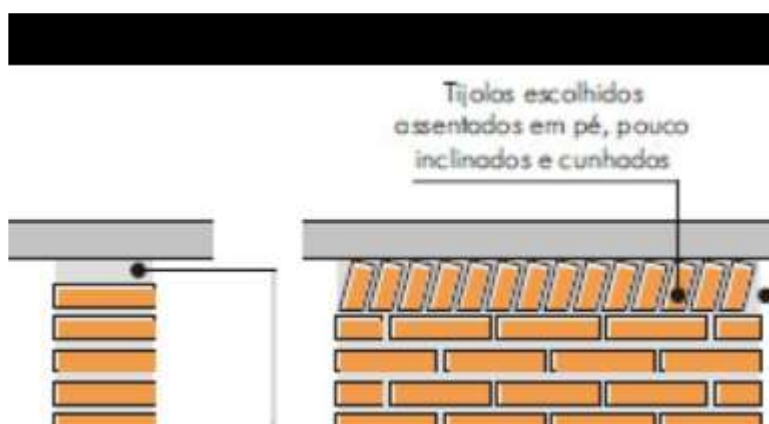
Figura 2 – Detalhamento de encunhamento. Fonte – FNDE 2013
