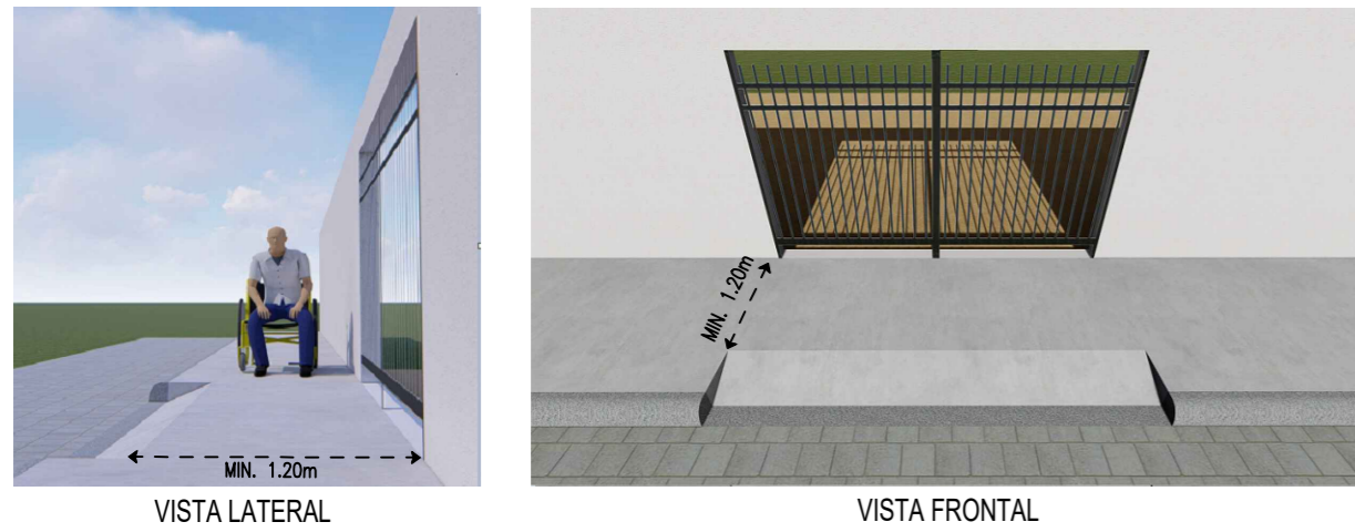
Esquema ilustrativo de possíveis ajustes de soleira das casas escala
