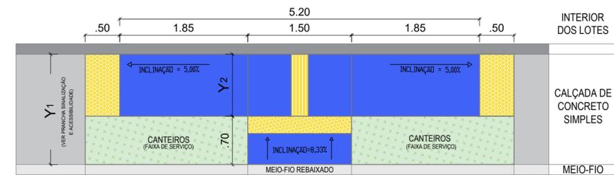
Detalhe 10 - Detalhe Rampa estreita com canteiros
