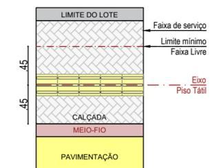
Detalhe 01 - Eixo do piso tátil a partir do meio-fio
