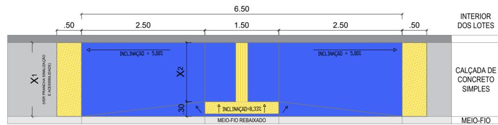
Detalhe 09 - Detalhe Rampa estreita
