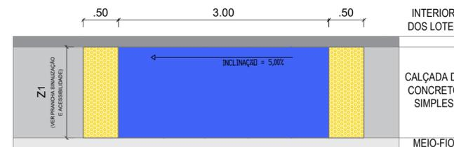
Detalhe 12 - Detalhe Rampa única
