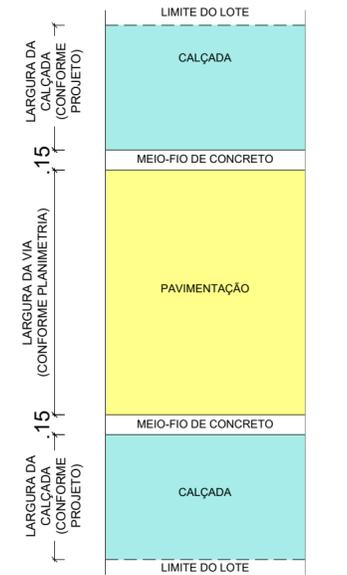
Croqui esquemático - ampliação da planimetria
