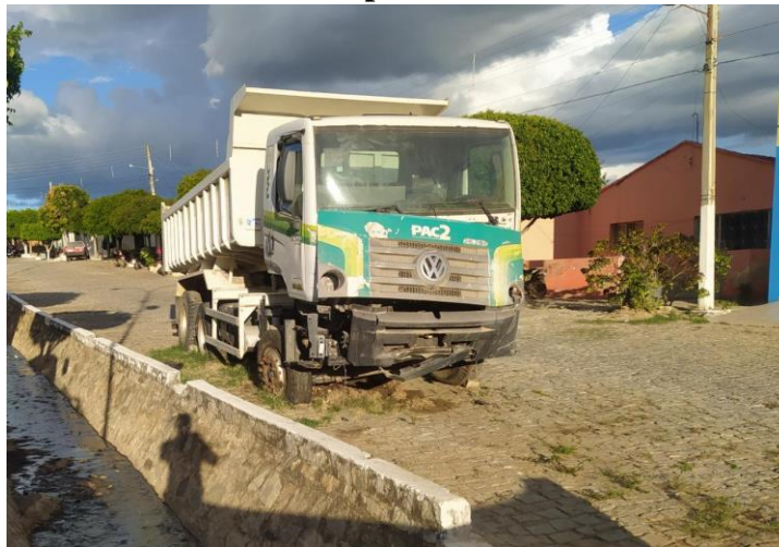
Figura 1 Caminhão basculante sem condições de funcionamento após acidente que deixou inoperante
