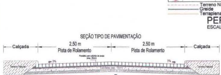
DETALHAMENTO DA SEÇÃO ESCALA 1/75
