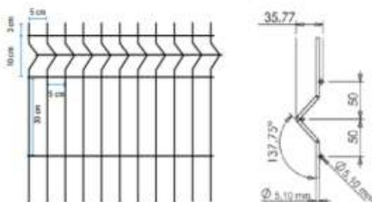
De acordo com o projeto padrão fornecido pelo FNDE (para terreno de 40 x 60 m), haverá fechamento com gradil de 1,58m de altura, com pilaretes metálicos e tela de aço galvanizado de tamanho fixo, instalado na parte frontal do lote, acima de mureta de alvenaria de 0,62m de altura. Caso o terreno disponível seja maior, o ente requerente poderá utilizar-se do padrão de fechamento aqui descrito para a instalação em todo o seu terreno, ficando o custeio do excedente a cargo do requerente.
