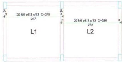
Armação positiva das lajes do pavimento Caixa D'água (Eixo X) escala 1:25
