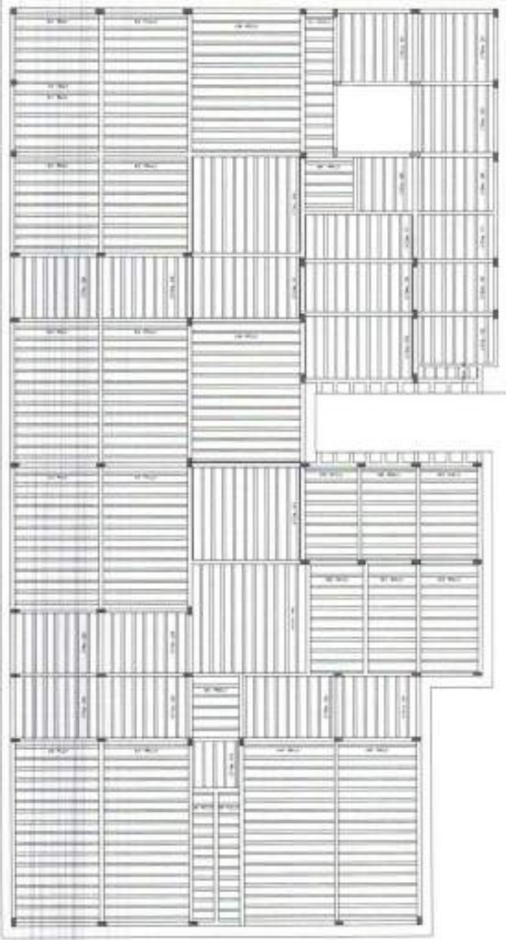
Planta de vigotas pre-moladas escala 1/50
