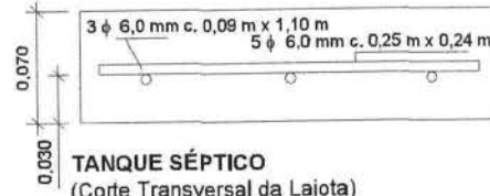
TANQUE SÉPTICO Planta e Armação da Lajota (08 unid por Tanque) Escala: 1:25
