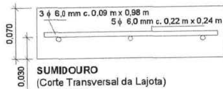
SUMIDOURO Planta e Armação da Lajota (04 unid por Sumidouro) Escala: 1:25
