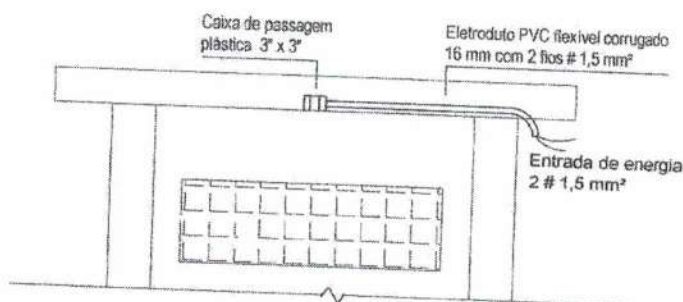
INSTALAÇÃO ELÉTRICA Entrada de Energia - Escala: 1:25
