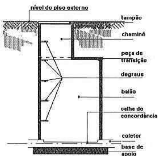
Figura 3. Exemplo de poço de visita
