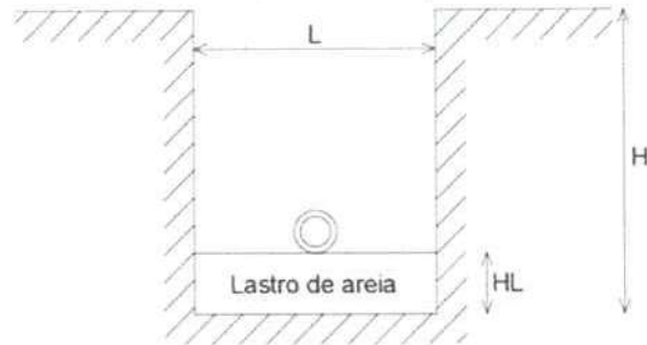
Figura 3.2 – Perfil das valas para instalação da rede de distribuição
