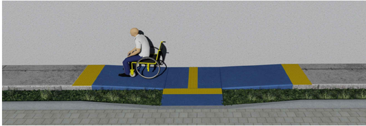
Persp. ilustrativa - Rampa estreita com canteiros
